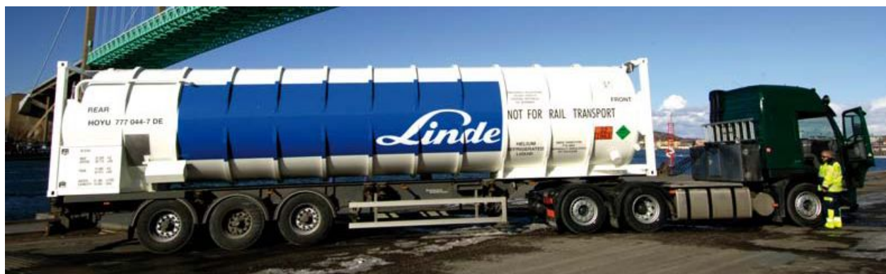
Bild 12: Trailer för transport av LBG (Källa: www.cryo.se)
